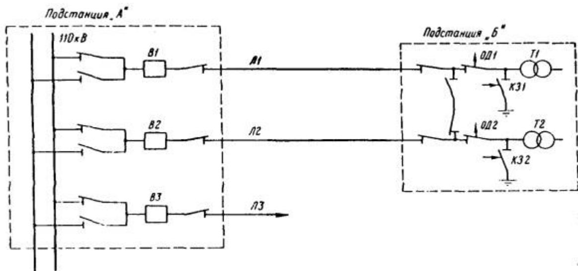
В - выключатель; Т - трансформатор; ОД - отделитель; КЗ - короткозамыкатель
